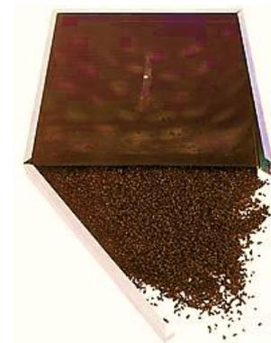
Le zeoliti sono dei tectoalluminosilicati con strutture cristalline costituite da tetraedri  $TO_4$ , le zeoliti rappresentano una classe di setacci molecolari con un'elevata selettività rispetto alla silice o al carbone attivo.
