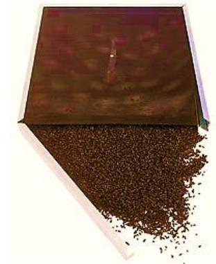
Le celle ad allumina (ossido di alluminio impregnato con  $KMnO_4$ ) trattengono l'umidità residua ed il vapore.
